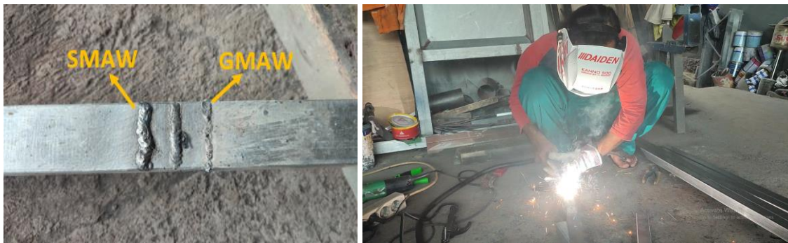
Gambar 4. Perbandingan hasil pengelasan dengan las SMAW dan las GMAW.
