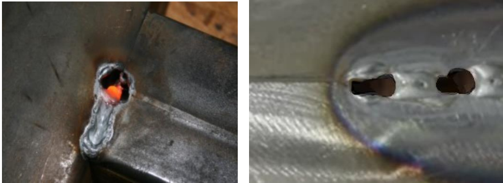
Gambar 2. Cacat Burn Through pada plat tipis.
