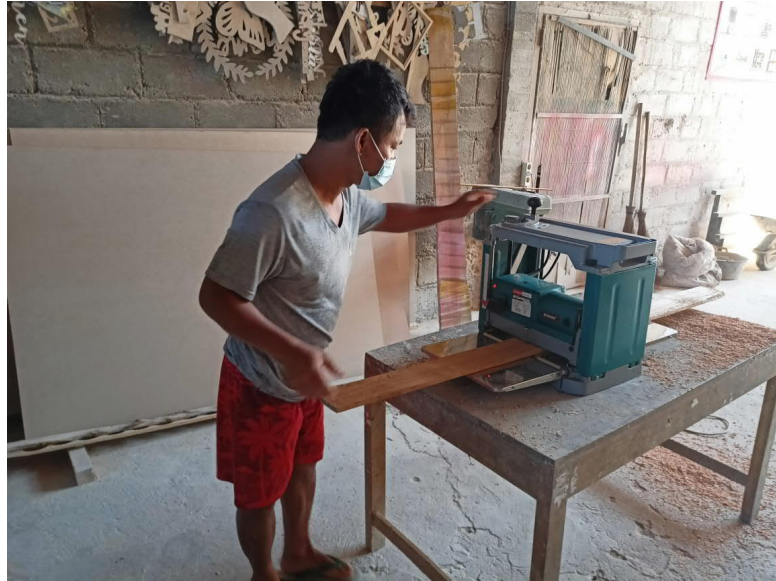
Gambar 3. Mesin Serut Kayu Meja duduk Portable Thicknesser Merk "MODERN" telah dimanfaatkan untuk proses produksi batik kayu oleh Tim Pengabdian yang diaplikasikan di UKM Sanggar Punokawan, Bantul, DI Yogyakarta
