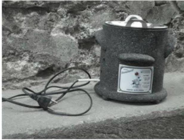
Spesifikasi teknis: Daya: 65 watt, Tegangan: 220 volt, Suhu kerja: 85°C – 90°C Gambar 1. Kompor listrik otomatis khusus untuk batik kayu
