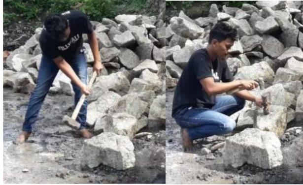
Gambar 7. Alat yang Digunakan untuk Membelah Batu(Bodem, Palu, dan Pahat)
