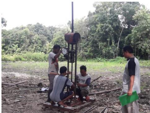
Gambar 12. Pengujian Sifat Tanah dengan Alat Sondir
