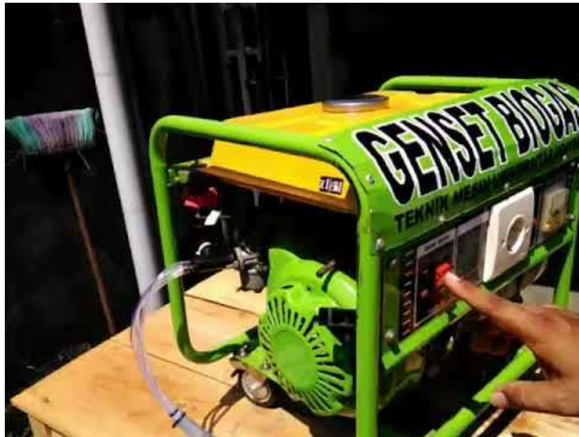
Gambar 5. Rancangan Alat Pembangkit Listrik Tenaga Biogas
