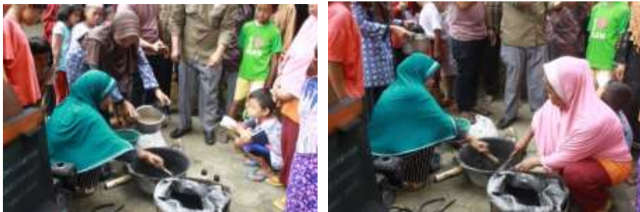
Gambar 6. Pencampuran serbuk arang dengan tepung tapioka yang sudah di olah dengan air
