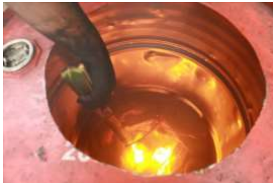
Gambar 4. Pembakaran Serabut Kelapa dalam Drum
