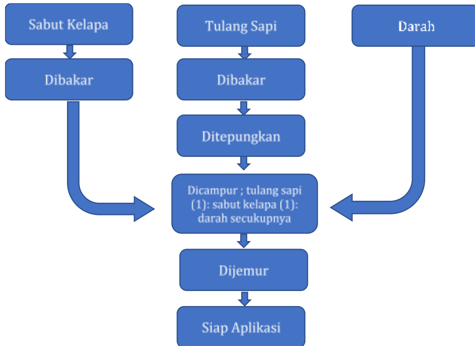
Gambar 2. Langkah pembuatan pupuk NPK organikTinggi nutrisi
