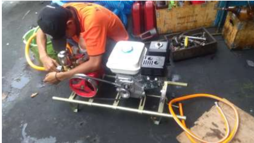
Gambar 13. Perakitan mesin penggerak dan sprayer
