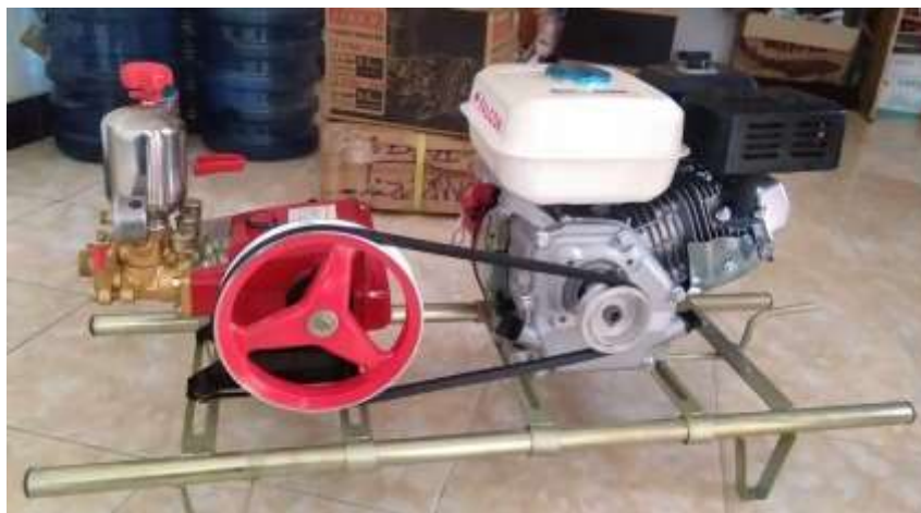
Gambar 9. Mesin penggerak dan compressor
