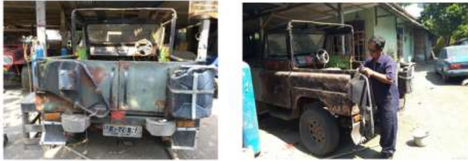
Gambar 3. (a) Mobil Jeep dari Merapi Lava Tour, (b) Pengerjaan chasis dan body Jeep
