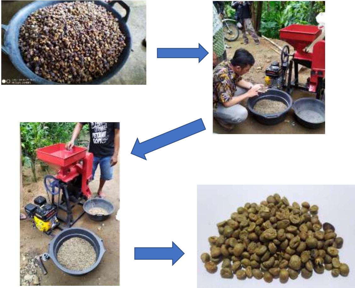
Gambar 5. Proses pengupasan kulit ari biji kopi kering.
