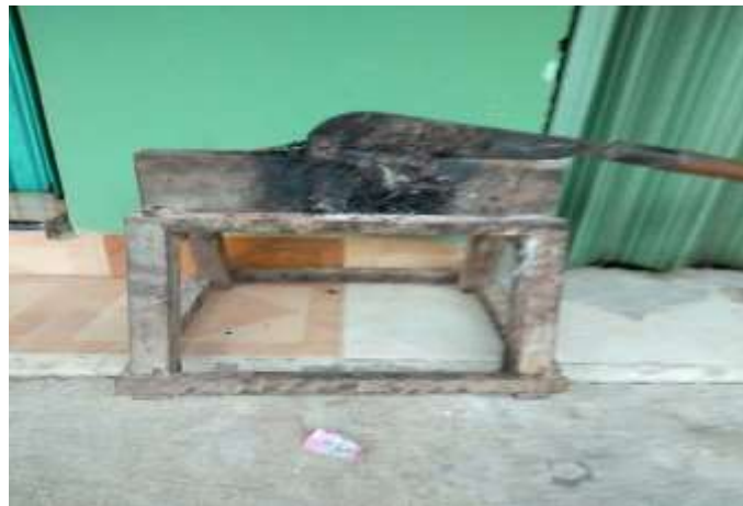
Gambar 1. "Kecip" Alat pengupas biji mete secara manual
