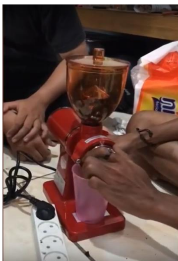
Gambar 3. Memasukkan Biji Salak ke Mesin Blender
