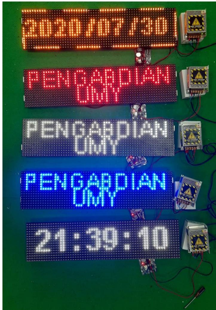
Gambar 7. Sistem *Display P10* Lengkap dengan Kontroler, FlashDisk, Catu Daya, dan *Display P10*
