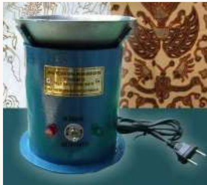
Gambar 1. Kompor listrik untuk batik berdaya 125 W.
