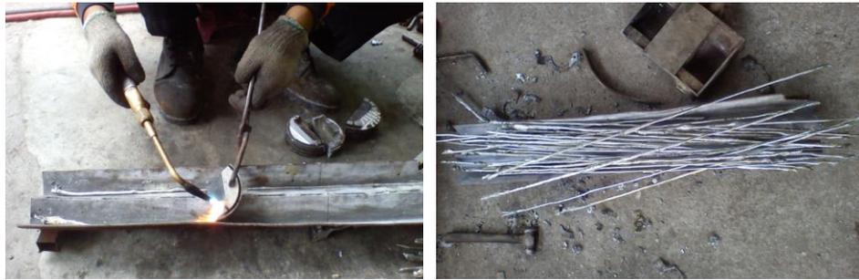
Gambar 3. Pembuatan filler material las asetilin.
