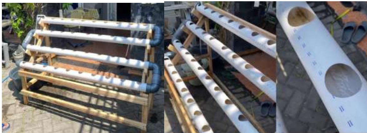
Gambar 2. Kerangka Hidroponik dan Gambar 3. Uji Coba Pengalirain Air Pipa PVC di Rangka Hidroponik
