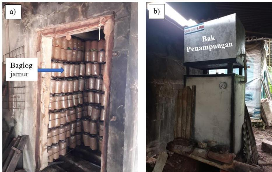
**Gambar 4.** Proses sterilisasi baglog jamur: a) Ruang *steamer*, b) Boiler dengan pipa pemanas dari pengabdian skema PPM-TTG di mitra pengguna Pesona Jamur
